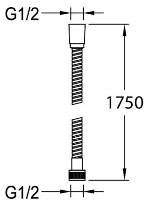
Descriptif CCTP : Flexible 175 cm. E75204. Collection : Hors collection. DIMENSIONS : 175 x 175 cm. POIDS : 0,3 kg. MATÉRIAU : Métal. TYPE D'ACCESSOIRE : Flexible de douche. TYPE DE FLEXIBLE : Anti-torsion. Flexible 1750 mm métallique double agrafage - 1 écrou conique tournant - 1 écrou droit.
