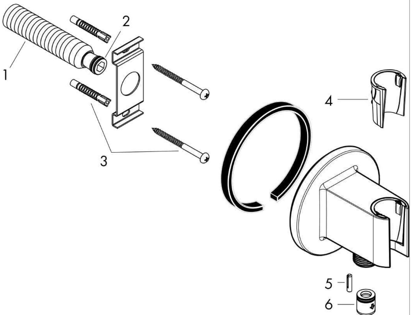
**FixFit****Coude de raccordement avec Porter S**Surfaces: **chromé** Numéro d'article: **26487000**
