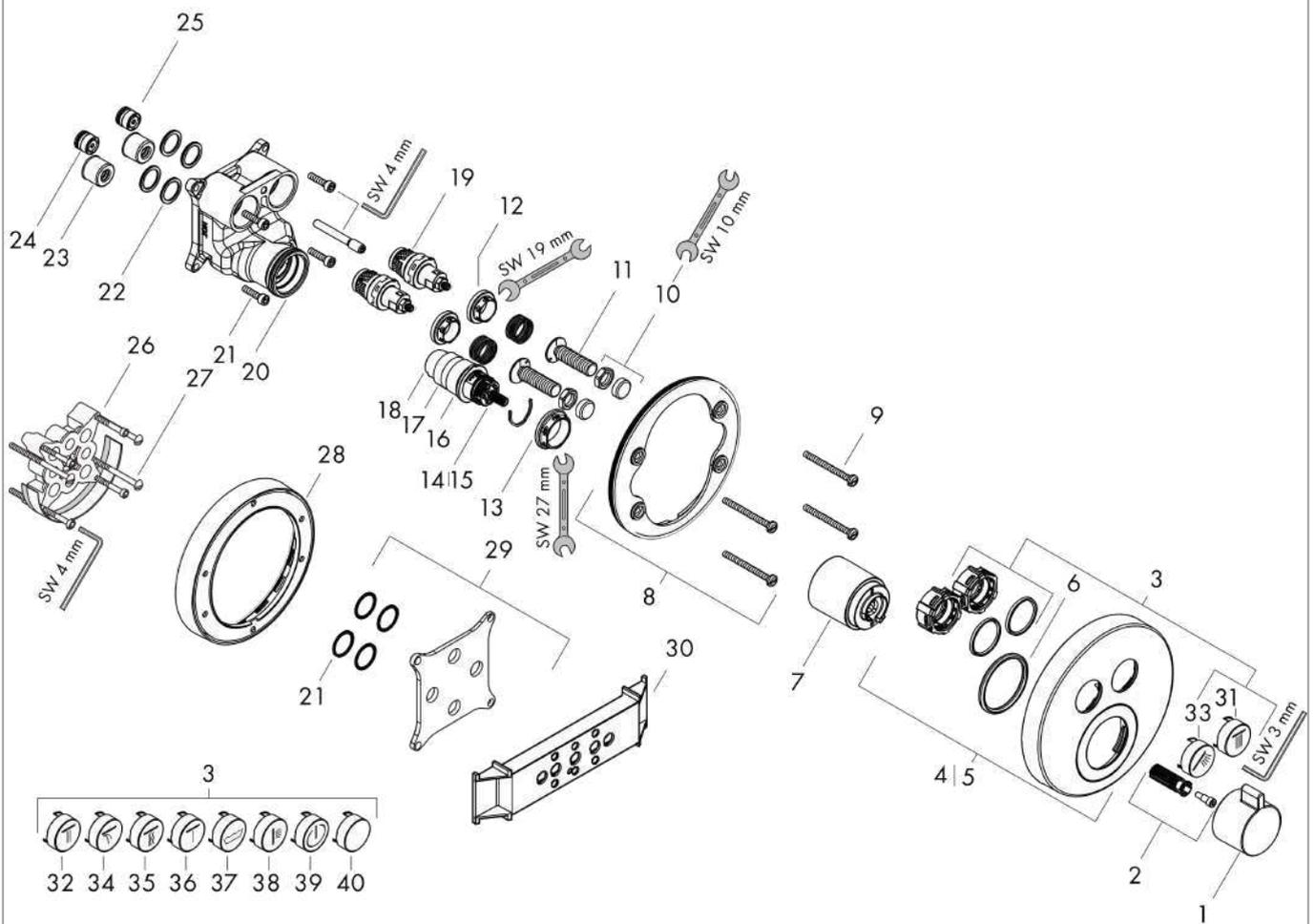
**ShowerSelect S****Set de finition pour mitigeur thermostatique encastré avec 2 fonctions**Surfaces: **chromé** Numéro d'article: **15743000**
