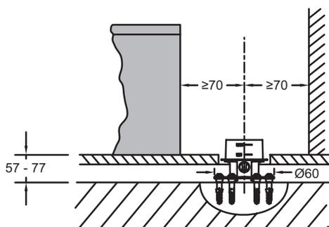
Descriptif CCTP : Base à encastrer pour mitigeur avec alimentation par le sol. 97906D. Collection : HORS COLLECTION. TYPE D'INSTALLATION : Au sol. TYPE : Mitigeur. MÉCANISME : Cartouche à disques céramique. TYPE D'ACCESSOIRE : Base à encastrer.
