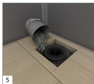
Remplir le chevêtre avec un mortier de scellement.
