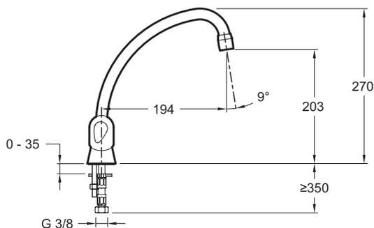
Description : Mélangeur évier bec tube orientable haut. E76920. Collection : GALÉO CD. Poids : 1,3 kg. Installation : Monotrou. Normes : NF : I - ECAU : E0 A2 U3. Débit : 14 l/mn sous 3 bars. Raccords : Avec flexibles d'alimentation. Mécanisme : Têtes à disques céramique. Poignées métal.
