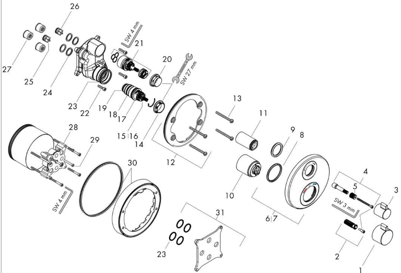
**Ecostat S****Set de finition pour mitigeur thermostatique encastré avec robinet d'arrêt et inverseur**Finition: **Chrome** Numéro d'article: **15758000**
