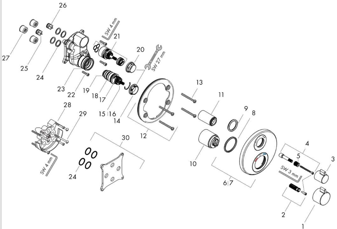
**Ecostat S****Set de finition pour mitigeur thermostatique encastré avec robinet d'arrêt et inverseur**Finition: **Bronze brossé** Numéro d'article: **15758140**
