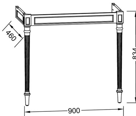
Descriptif CCTP : Console 90 cm. EB727. Collection : CLÉO 1889. DIMENSIONS : 90 x 46 x 83,40 cm. POIDS : 10 kg. MATÉRIAU : Laque. TYPED'INSTALLATION : Posé. DISPOSITION VASQUE : Centrée. FIXATION : Set de fixation à déterminer par votre installateur en fonction de votre support mural. INFOS COMPLÉMENTAIRES : Céramique non incluse. DURÉE GARANTIE (ANNÉES) : 5.
